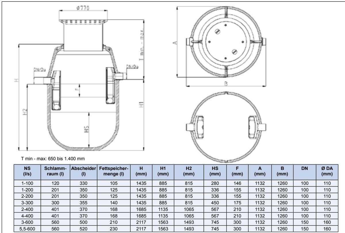
TOPATEC PE-Fettabscheideranlage AQUA-LIPOMASTER FE (bis Abdeckklasse B 125)
