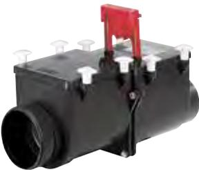
Automatisch wirkende Rückstauklappen aus Edelstahl, zusätzlicher Handabspernung (Notverschluss), Verschlussgestänge aus Edelstahl, Prüfrohranschluss, wartungsfreundlichem Gehäuse aus schlagfestem ABS-Kunststoff mit Knebelschrauben zur Wartung ohne Werkzeug
