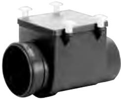
Automatisch wirkende Rückstauklappe aus Edelstahl, wartungsfreundliches Gehäuse aus schlagfestem ABS-Kunststoff mit Knebelschrauben zur Wartung ohne Werkzeug
