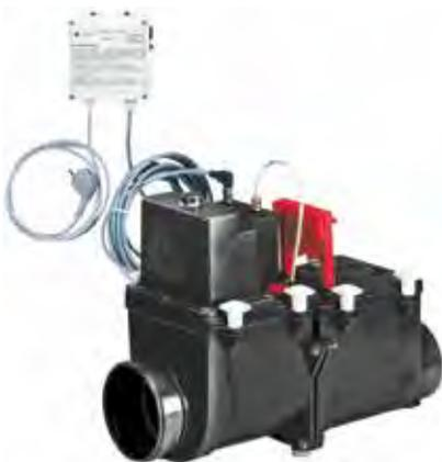
Zwei, im Normalbetrieb geöffnete Rückstauklappen, eine bei Rückstau automatisch schließend, eine als Notverschluss und zur Funktionskontrolle manuell verriegelbar, ein elektronisch gesteuerter Klappenverschluss, Elektromotor in wasserdichtem Gehäuse, Notstromversorgung über Batterien, Prüfrohranschluss, wartungsfreundliches Gehäuse aus schlagfestem ABS-Kunststoff mit Knebelschrauben zur Wartung ohne Werkzeug, Steuerelektronik in Aufputzbox, optisch/akustische Statusanzeige, GLT-fähig
